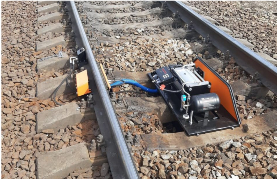
Стационарный путевой рельсосмазыватель СПР-Лайт в комплектации с пластиной и гидравлическим насосом.
