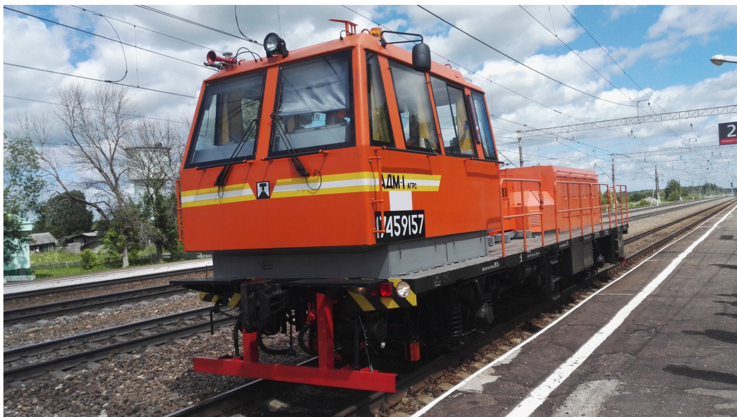
Автомотриса АДМ-1 агрс с установленным рельсосмазывающим оборудованием.
