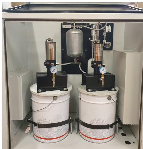
Система хранения смазки, используемая на рельсосмазывателях типа РСЛ. Забор смазочного материала происходит непосредственно из тары завода производителя.
