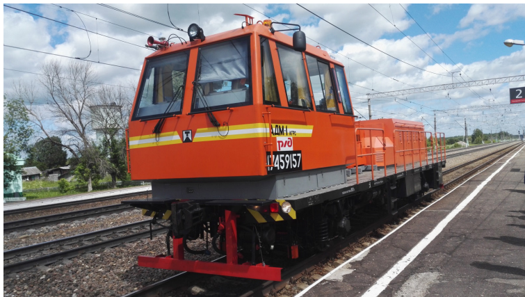
Автомотриса АДМ-1 агр с установленным рельсосмазывающим оборудованием.
