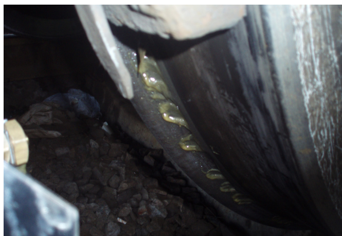
Нанесение смазки на гребень колеса системой АГРС - 1.
