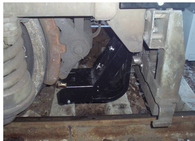
Система АГРС - 1, установленная на электропоезде.
